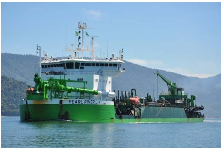
TSHD 'Pearl River' voert verdiepingsbaggerwerken uit in Porto Sudeste in de baai van Sepetiba, Rio de Janeiro, Brazilië.
